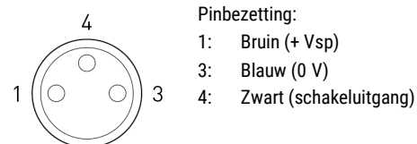
Afb. 6.23: Pinbezetting: Eindschakelaarstekker
